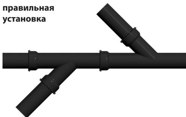
Рис. 2. Горизонтальный трубопровод – ответвление от главного трубопровода
