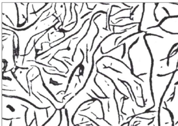
Серый чугун (углерод в форме пластин)
