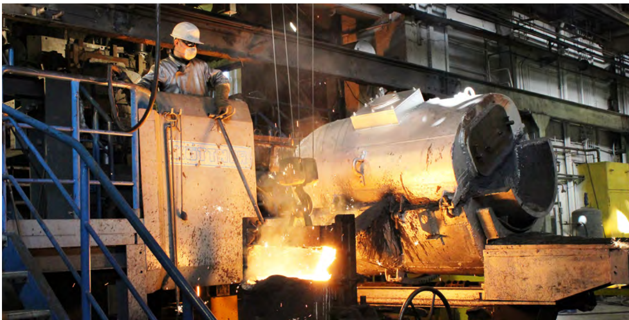
Процесс плавки: забор жидкого чугуна из вагранки
