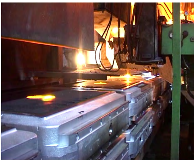
Формовочная линия: литьё в песчаные формы
