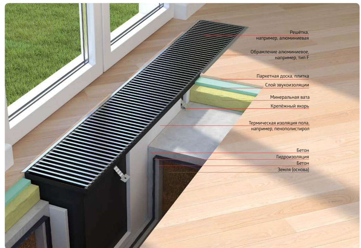
Пример монтажа глубокого внутрипольного конвектора
